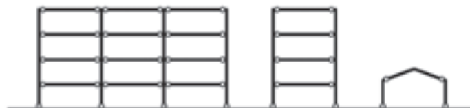
Slika 8: Pomični okvir (večja podajnost). Moment resisting frame (greater elasticity).
