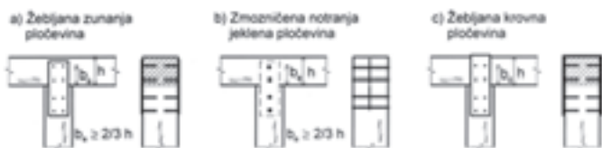
Slika 4: Primeri sprejemljivih ukrepov v primeru nateznih napetosti pravokotno na vlakna.
