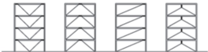
Slika 11: Okvir z ekscentričnimi povezji (manjša podajnost). Frame with eccentric bracings (lesser elasticity).
