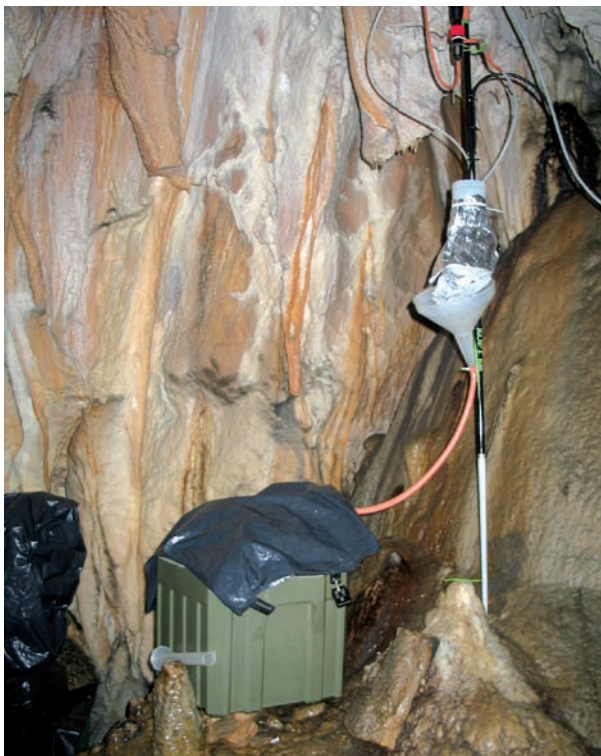
Sl. 4: Merjenje pretoka curka J v Kristalnem rovu.
