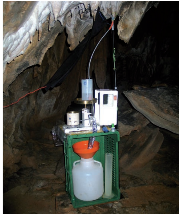
Sl. 5: Merjenje pretoka na točki L v Kristalnem rovu.
