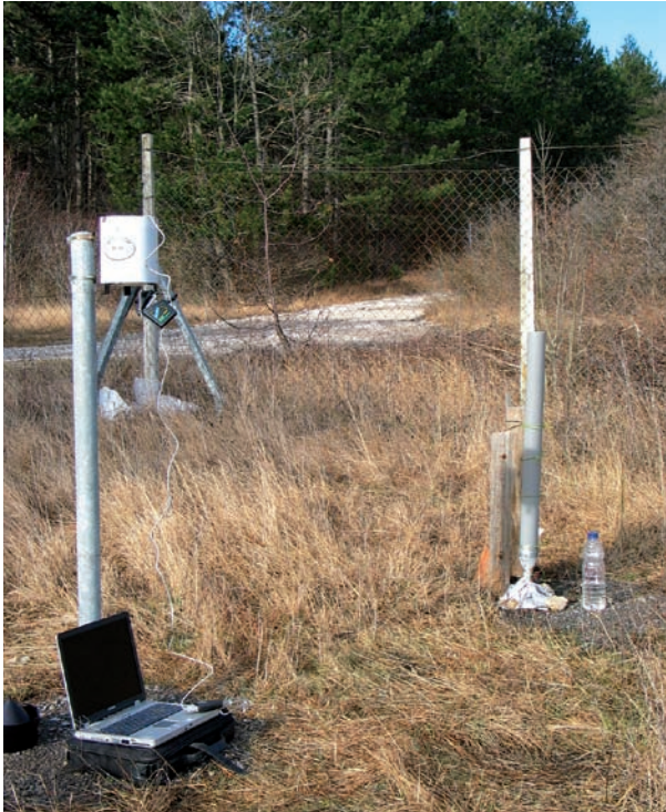
Sl. 2: Meritve padavin so potekale z dežemerom z dataloggerjem HOBO Event Logger.
