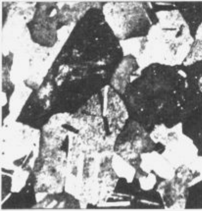
Figure 5: Microstructure of lead. Slika 5: Mikrostruktura svinca.
