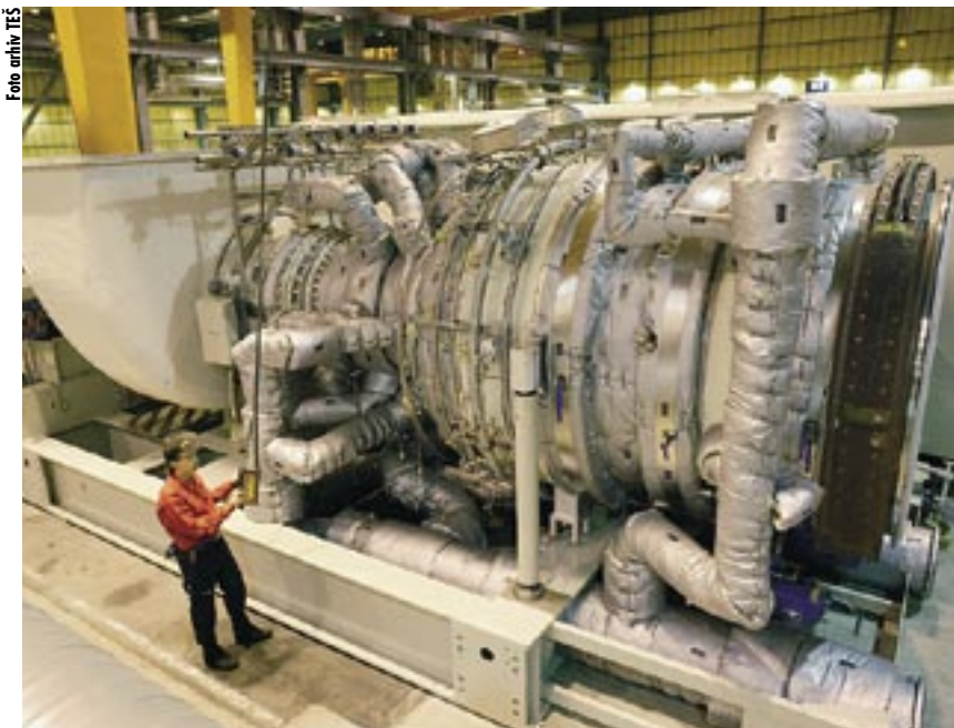
Plinska turbina SGT800 proizvajalca Siemens.
