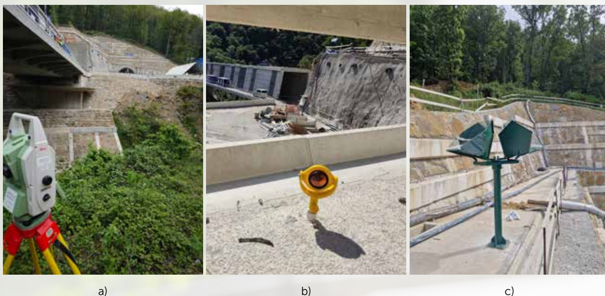
Slika 2: Oprema in izvedba monitoringa v Glinščici: a) tahimeter v času izmere površinskih točk pod viaduktom Glinščica; b) signalizacija površinskih merskih točk; c) umetni sipalec InSAR.
