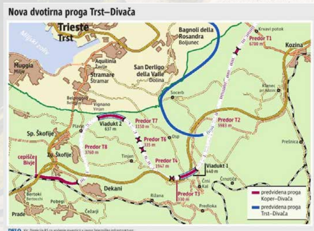
Slika 1: Proga Trst–Divača s priključkom na progo Divača–Koper na območju Črnega Kala (arhiv: Delo)
