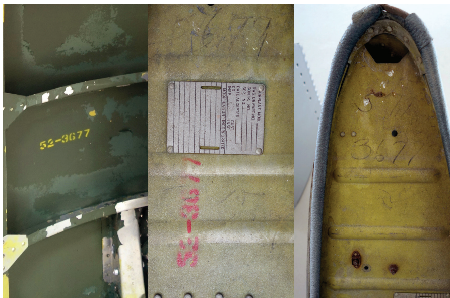
Izvirne serijske številke letala 14325 (52-3677) so odtisnjene tako na tovarniških ploščicah kot tudi na posameznih delih letala. Nekateri deli imajo številke izpisane kar s svinčnikom. (Foto: Tomaž Perme)
