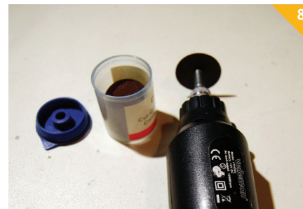
Rezalna ploščica za izdelavo pravokotnih odprtin, vpeta v vrtalnik
