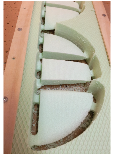
Krilni zaključki so tridimenzionalno izrezani iz stirodura.
