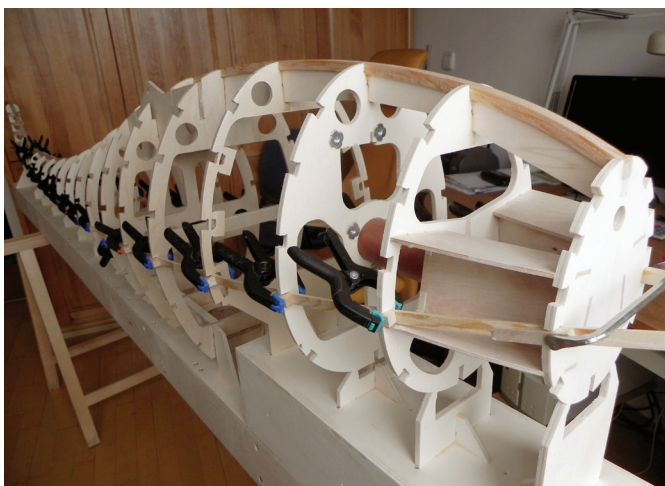
Lepljenje vzdolžnih letvic iz več plasti med nastajanjem trupa
