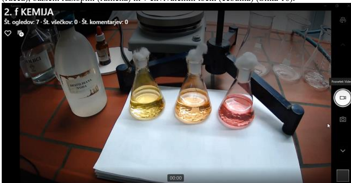
Slika 10: Indikator metiloranž v bazični raztopini, ekvivalentni točki in v kisli raztopini.
