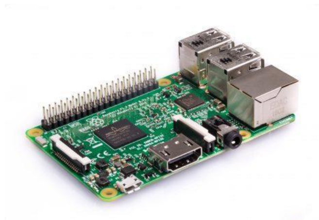
Slika 1: Mikroračunalnik Raspberry Pi Model 3
