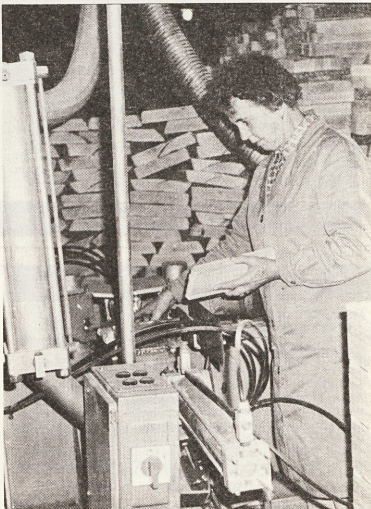
Stroj za čelno profiliranje hlačnih spon (izdelek TOZD Podpeč)
