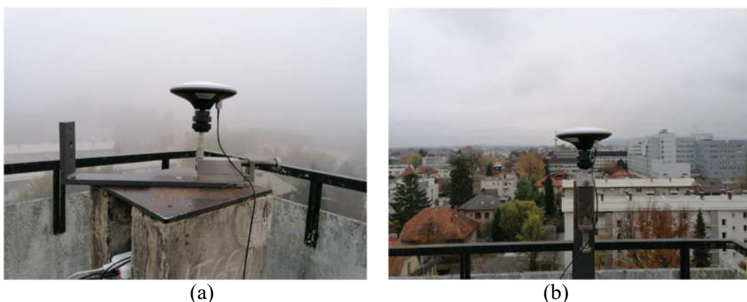
Slika 10. Vsiljevanje horizontalnega premika (a) in premika po višini (b) za testiranje zmožnosti zaznavanja premikov s cenovno ugodnimi inštrumenti GNSS
