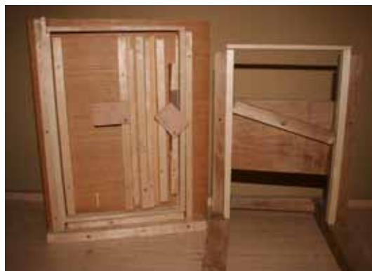
Šablona za zbijanje satnikov – Dva primera šablon iz domače delavnice za zbijanje satnikov
