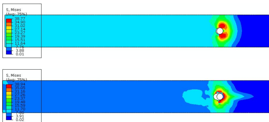
Slika 2.19: Napetostno stanje preizkušanca B-1-1 pri pomiku 1,0 in 3,2 mm
