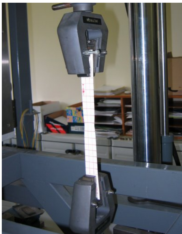
Slika A.6: Natezni preizkušavec (jek. trak) vpet v preizkuševalno napravo (zožitev preizkušanca pri \varepsilon \approx 30\% )
