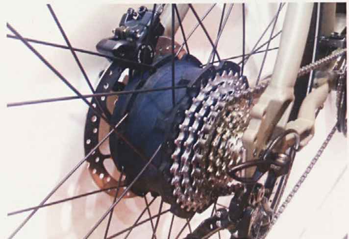
Domelov motor, vgrajen v zadnjem kolesu znamke AEG.
