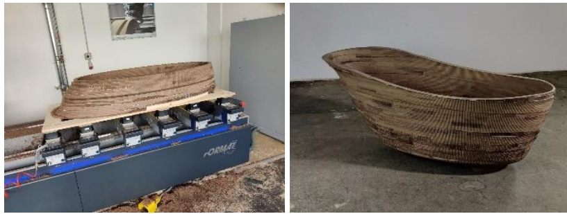
Slika 6: Prikaz izdelave in končane lesene kadi (Rožanski, 2020)
