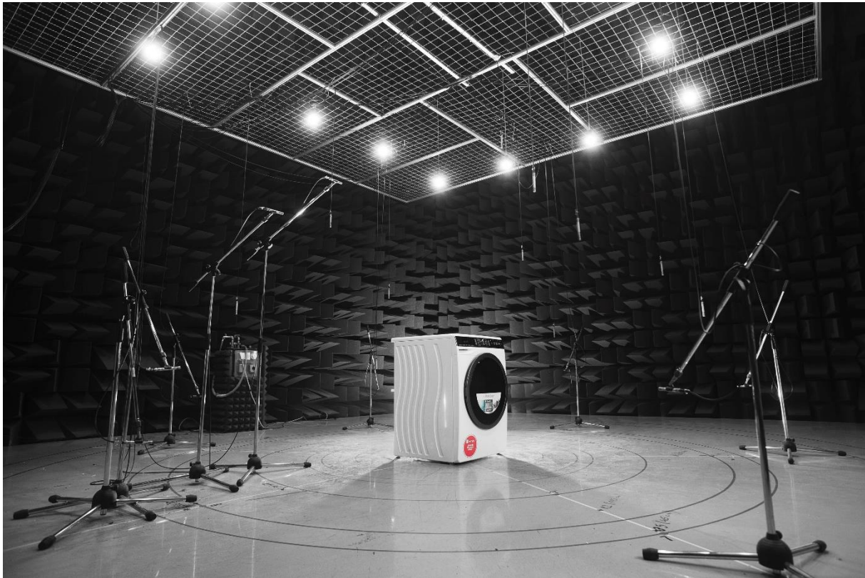
Slika 2 : Izvedba meritev za zvočno moč v akustičnem laboratoriju v Gorenju
