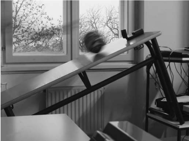
Slika 1. Postavitev poskusa s kotaljenjem žoge.
