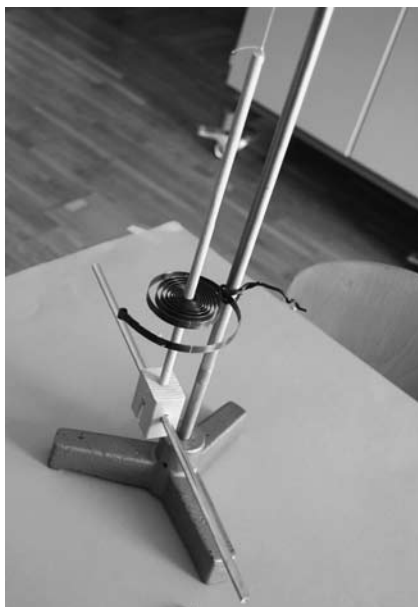
Slika 4. Nihalo na polžasto vzmet. Vzmet je s togo žico pritrjena na navpično stojalo.
