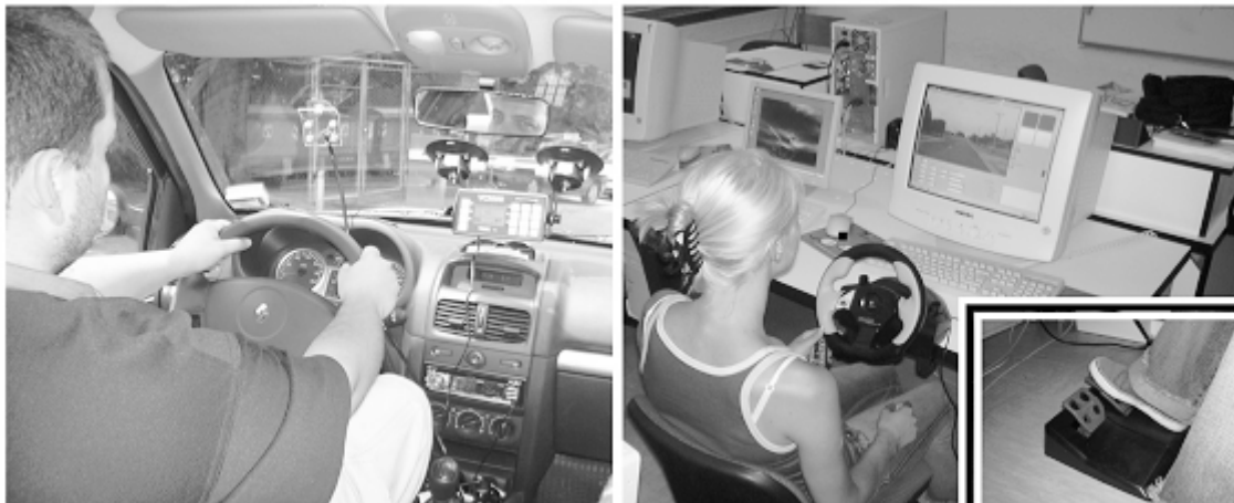
Sl. 4. Meritve reakcijskega časa voznika v dejanskih voznih razmerah (oprema za vidno spodbudo je nameščena v smeri pogleda voznika naravnost naprej) in v simuliranih voznih razmerah na simulatorju PC osnove (vidna spodbuda je na robu zaslona)
