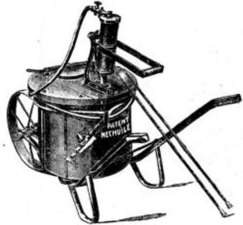
Pod. 49. Vozna škropilnica za hmeljne in sadne nasade „Unikum 2064“.
