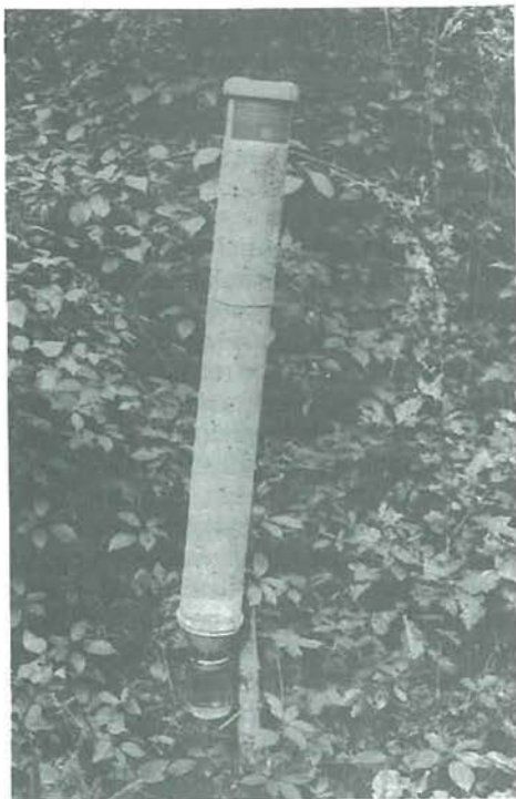
Slika 1: Cevna lovna past domače izdelave
