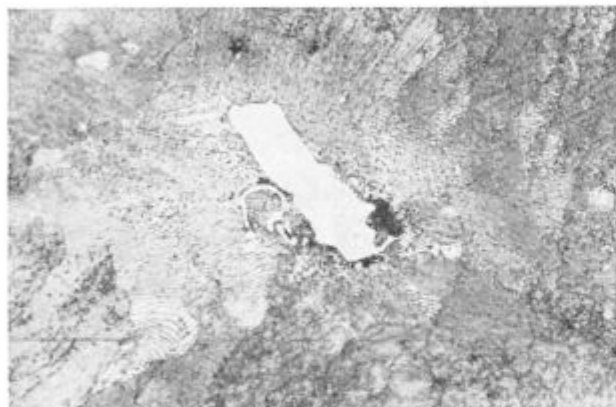
Slika 2 × 500, poligonalno karbidno zrno
