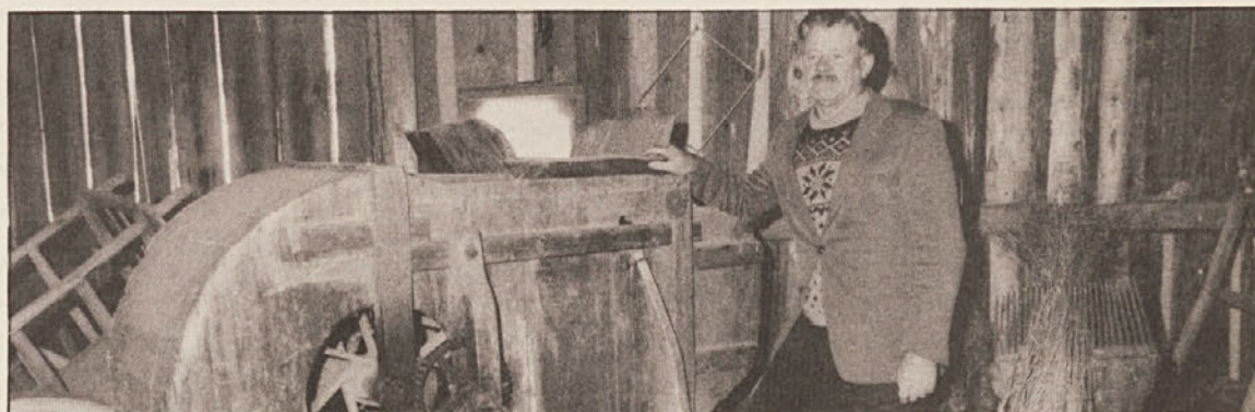
Predsednik kostanjskega društva Janez Lesjak je začel zbirati staro kmečko orodje, da bi s tem lahko prikazal mladim, kako težavno je bilo včasih delo na kmetih. Na sliki vidite Janeza Lesjaka pred vejnikom, v katerem se loči plevel od žita.
