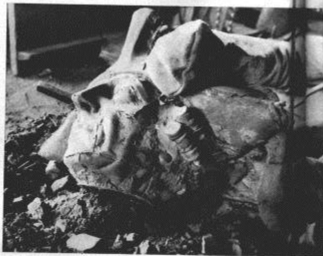
Unten: Das eben fertiggewordene Gussstück. Der Kopf zu einem Denkmal Friedrichs des Großen wird vom Sande befreit. Noch ist es mit Wurzeln und Kernstüben bedeckt. Jede Vollplastik bedarf daher erheblicher Nacharbeit
