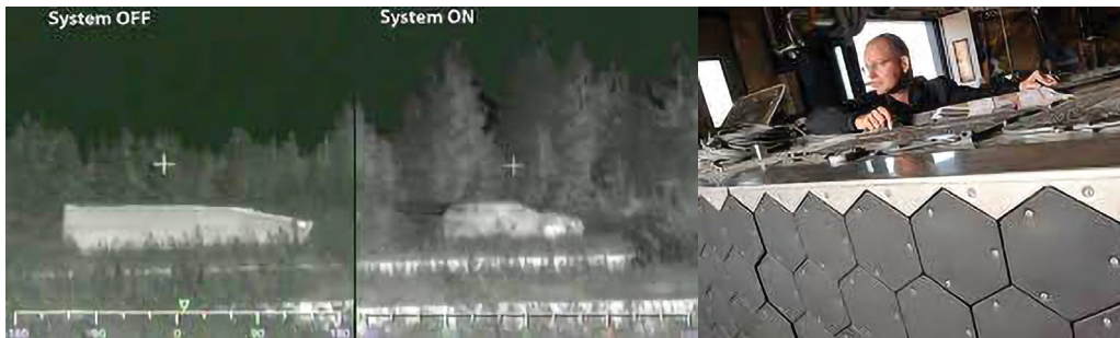
Slika 1: Aktivno maskiranje, sistem Adaptiv (vir: BAE Systems, 2021)
