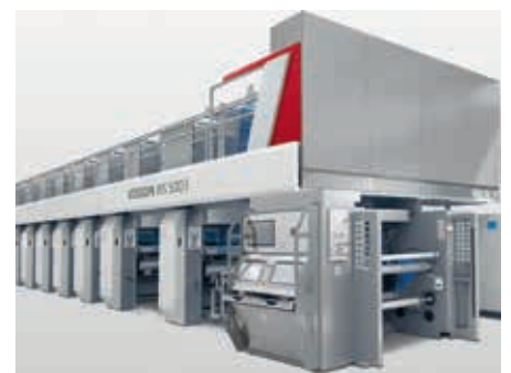
Gravurni tiskarski stroj Vision RS 5003 s tiskom na gibke embalažne materiale s hitrostjo do 450 metrov na minuto
