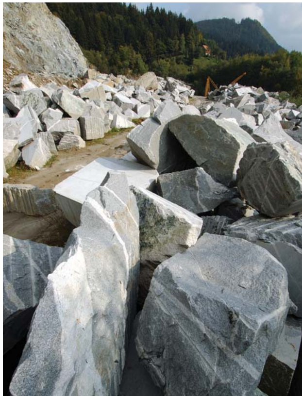
Slika 8: Ob rezanju ogromnih kosov kamna se lahko ob robovih kamnina krusi in tako nastajajo manjši kosčki, ki jih nato porabijo za kocke ali plosce (foto: Domen Grögl)..
