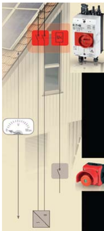
Slika 3: Primer vgradnje DC-ločilnega stikala za dvopolno prekinitev povezave PV-generatorja s pretvornikom. Stikalo se vgradi v povezavo v neposredni bližini PV-modulov. Stikalo lahko izklopimo tudi z izklopom krmilne napetosti – s posebnim stikalom STOP, ki ga namestimo na lahko dostopnem mestu. (Vir: EATON)
