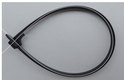
Slika 5. Upogib kableske plastične vezice. Svetla krivulja je lemniskata.
