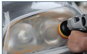
Slika 6: Mokro brušenje z brusilnikom. Vir: Gogić (2022)
