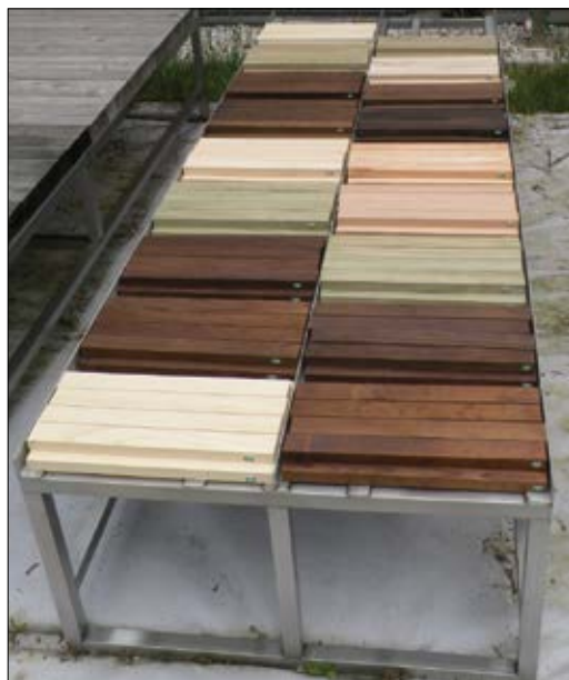
Slika 1: Izpostavitve vzorcev v skladu z dvoslojnim testom v Ljubljani
