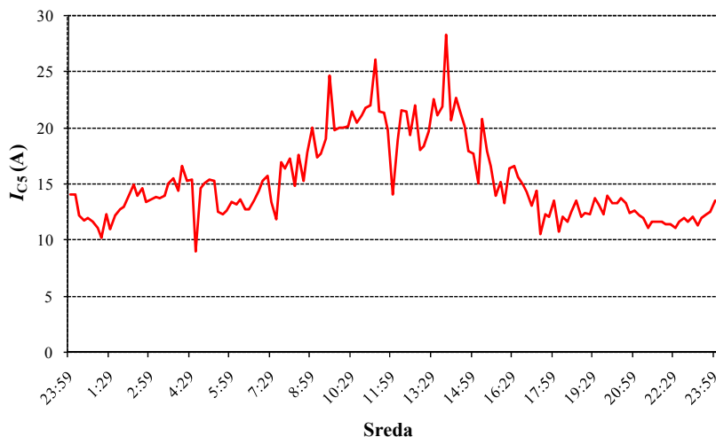
Slika 4.16: 5. harmonska komponenta toka na PM (TP Stara) za delovni dan (sredo)
