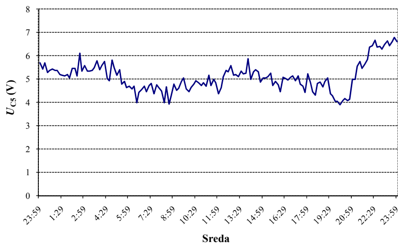
Slika 4.11: 5. harmonska komponenta napetosti na PM (TP Stara) za značilen delovni dan (sredo)
