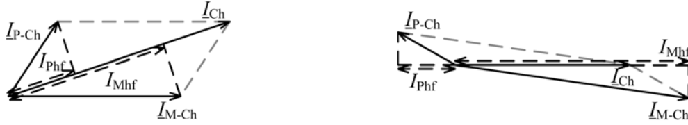
Slika 2.4: Prispevki porabnika in omrežja k harmonskemu popačenju toka na priključnem mestu porabnika
