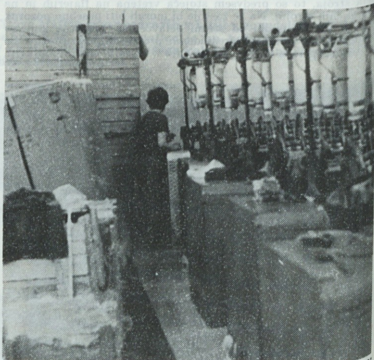
Ob strojih in med stroji morajo biti zadosti široki prehodi za nemoteno posluževanje strojev
