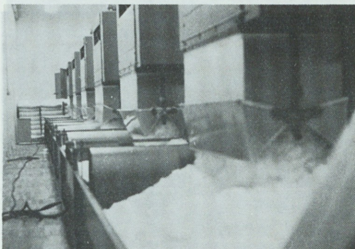
Iz rahljalnika padajo zrahljana vlakna na gumijast tekoči trak potem, ko naprave za tehtanje določijo potrebno količino
