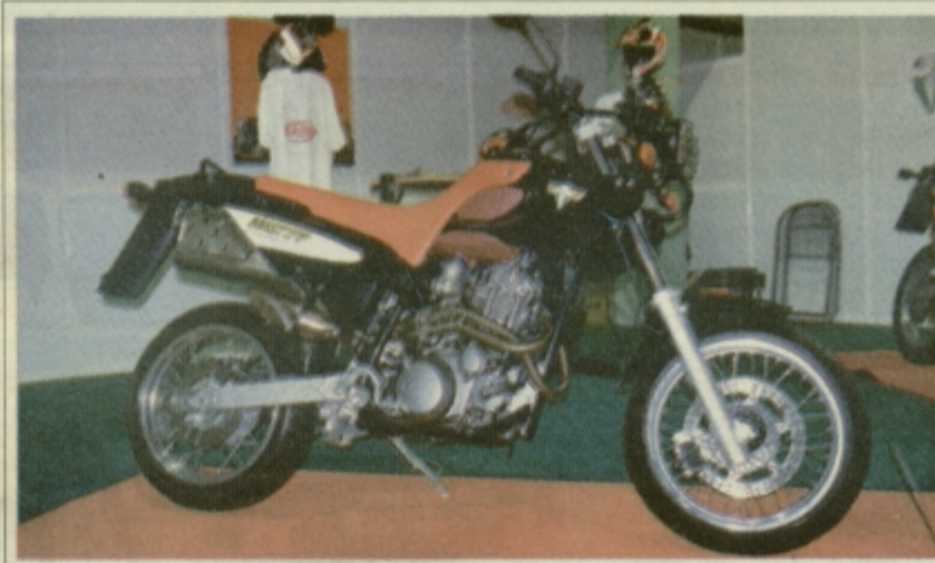
Husqvarna SM 610 zaokroža novo generacijo štiriventilskih enovaljnikov z elektrozagajanjem in protivibracijsko gredjo.
