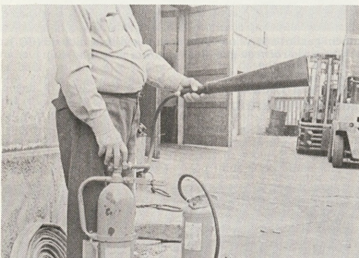
Aktiviranje ročnega gasilskega aparata na ogljikov dioksid (CO 2 ) s pomočjo odpiralnega ventila.
