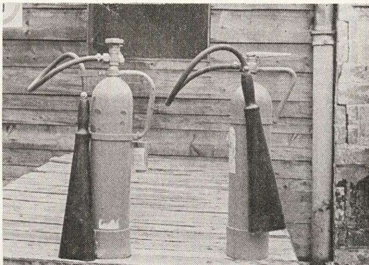
Ročni gasilni aparat CO 2 na odpiralni ventil in ročni gasilni aparat CO 2 z vzvodom za aktiviranje.
