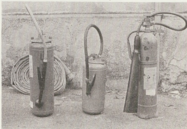
Ročni gasilni aparat na vodo, prah in ogljikov dioksid (CO 2 ). Aktiviranje ročnega gasilnega aparata na prah (»S«).
