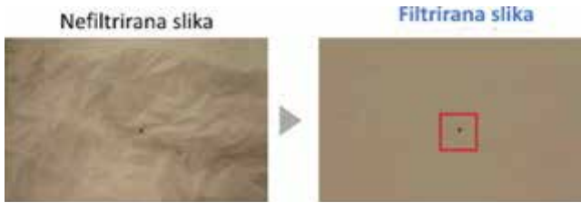
Slika 5 : Prikaz napake na nagubani površini
