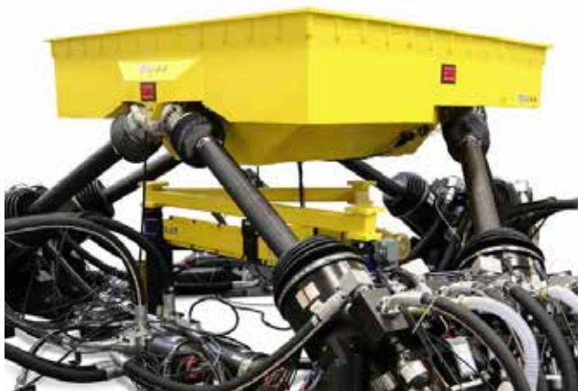
Slika 7 : Hidravlična simulacijska ploščad 353.50 (tloris 2500 mm x 2500 mm) [8]
