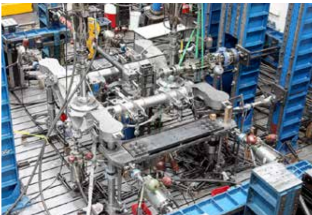
Slika 4 : Trajnostno preskušanje voznega podstavka tirnega vozila
