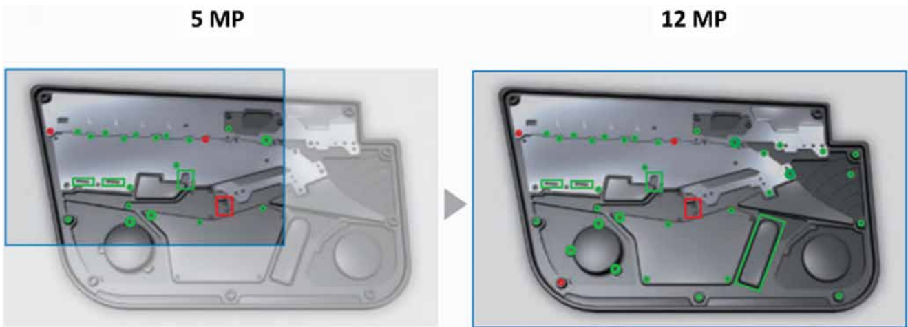
Slika 2 : Zajemanje slike in merilnih mest s kamero ločljivosti 5 MP in 12 MP
