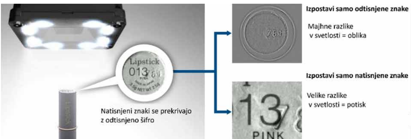
Slika 3 : Fotometrična stereo osvetlitev
