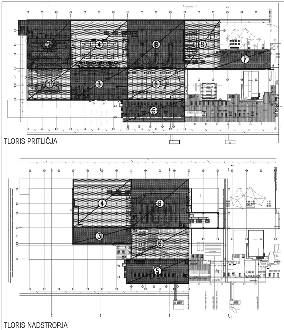
Slika 11 • Shemi dilatacijskih enot.
