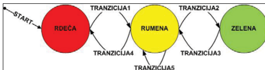
Slika 3. Primer končnega avtomata za semafor
