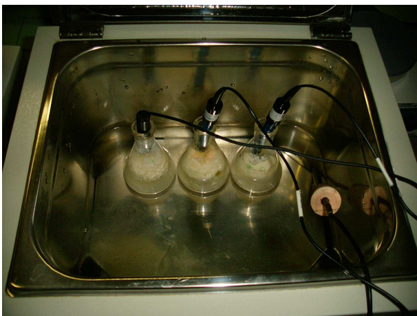
Slika 20: Merjenje pH mleka v termostirani vodni kopeli.
