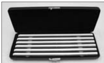
Slika 2: Keramični nosilci v škatli za shranjevanje. Keramični nosilci so podolgovate posode, v katere položimo IPG-trakove in nanje nanesimo vzorce v rehidracijski raztopini. V njih poteka izoelek- trično fokusiranje.
