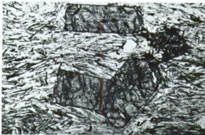
Sl. 2. Temno sivkasto zelen drobnozrnat biotitno muskovitni blestnik s stavrolitom in kloritom. Veliko lusk muskovita meri le okrog 0,15 mm.
