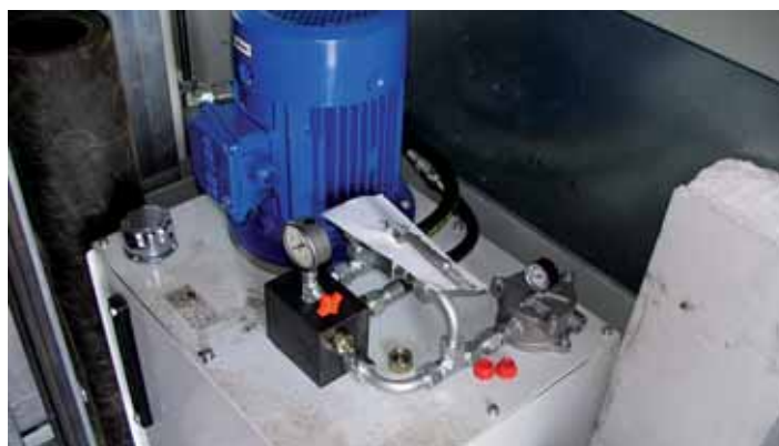
Hidravlični agregat za pogon dvigalk pri dviganju iztirjenih vozil.
