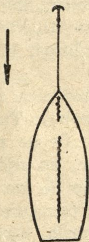
Sl. 120. Dviganje jader na zasidrani jadrnici.
