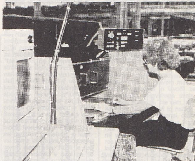
Univerzalni avtomatski stroj za vstavljanje elementov v Gorenju Elektronika Široka potrošnja. Večino dela opravi računalnik.
