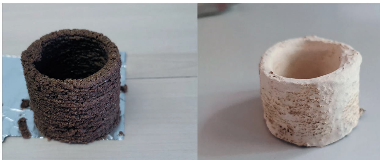
Slika 3. Natisnjena posodica pred preraščanjem z micelijem (levo) in po preraščanju (desno) (Foto: Blaž Žuran).
