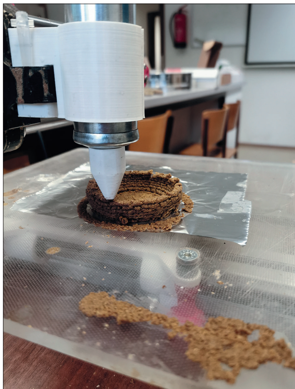
Slika 2. 3D tiskanje s pasto iz mešanice substrata, glivnega inokuluma in sredstva za želiranje, v tem primeru koruznega škroba (Foto: Blaž Žuran).
