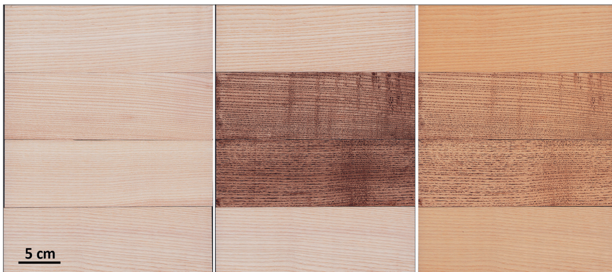
Slika 6. Jesenovi vzorci pred (levo) premazovanjem z bioimpregno oljem in po njem (v sredini) ter po UV izpostavitvi (desno).
