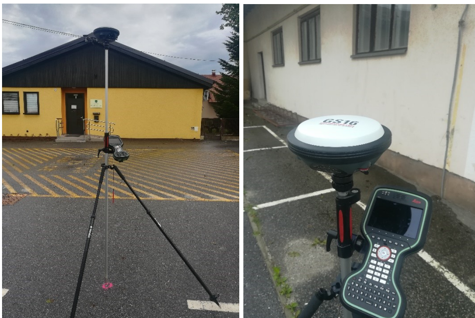
Slika 5.5: Primer GNSS izmere na testni točki 1201.
