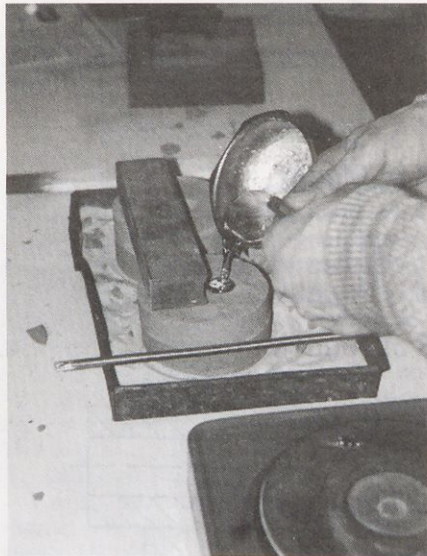
Slika 4. Formi sta sestavljeni in obeženi, da med ulivanjem tlak kovine ne bi dvignil njihovih zgornjih delov. Staljeni svinec smo previdno ulili skozi ulivno čašo in z njim zapolnili livno votlino.
