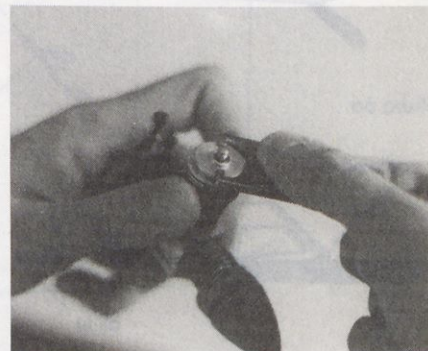
Slika 1. Odvijanje glave motorja s posebnim ključem
