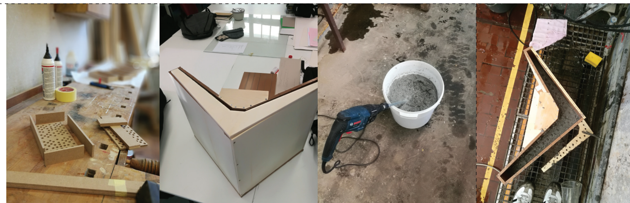
Sliki 1 in 2: Izdelava kalupov za preverjanje konsistence mase, uporabljene v končnem prototipu
