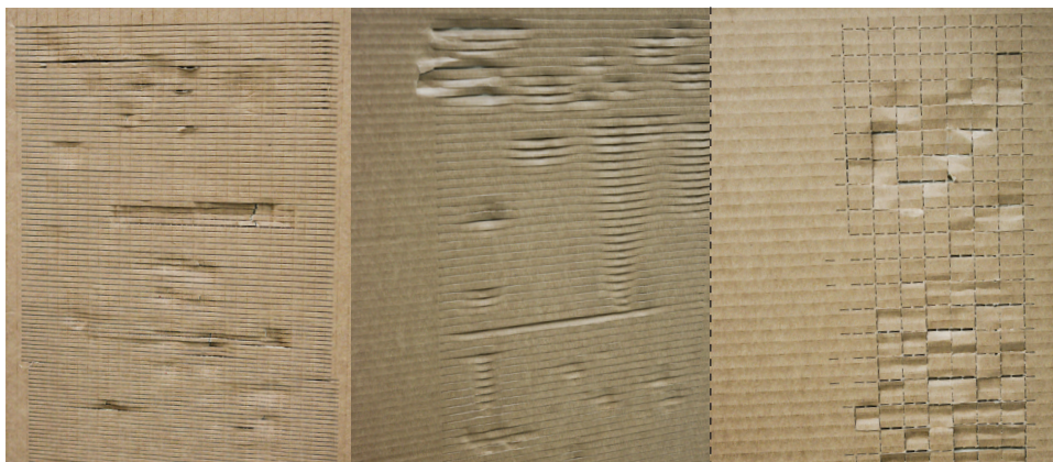
Slike 4-6: Testiranja vzorca z rezalnikom kartona: vzorec, pravokoten na val (levo); vzorec, vzporeden z valom (sredina); kompleksen vzorec (desno)
