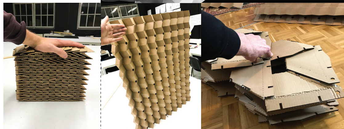
Slike 2-4: Prvi prototip in test modula za gradnjo pregradne stene
