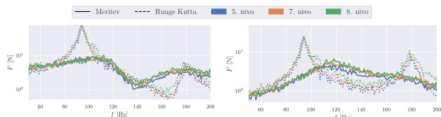
Slika 3: Primerjava meritev sile z rezultati numeričnih preračunov za kontakt aluminij-jeklo. Levo prva prostostna stopnja, desno druga prostostna stopnja.
