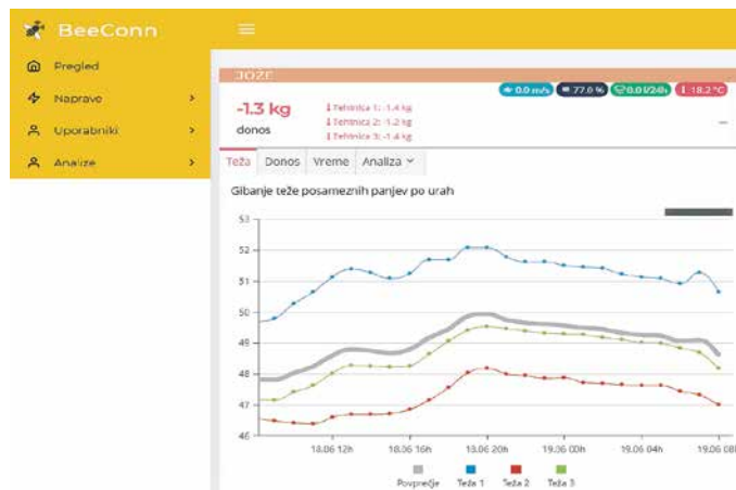
Spletna in mobilna aplikacija BeeConn prikazuje primer urnega spremljanja teže treh tehtnic v čebelnjaku.
