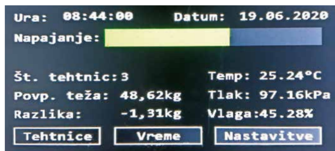
Osnovni oz. začetni prikaz podatkov na koncentradorju za spremljanje podatkov iz treh tehtnic v čebelnjaku
