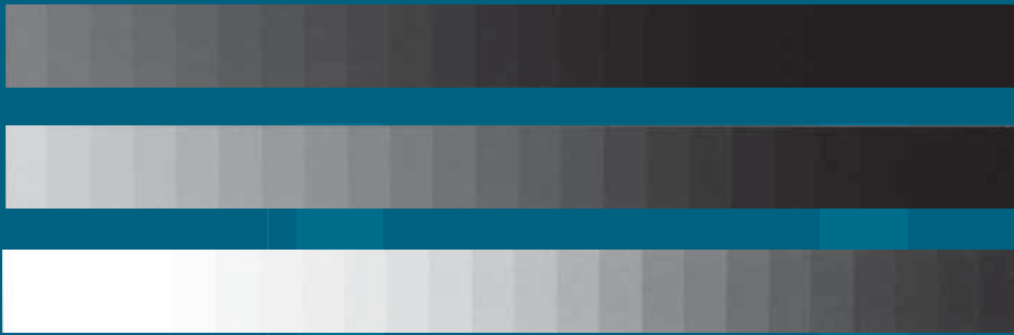
Slika 1: Posnetek Kodakove Q60 sive skale, zajet pri ekspoziciji: zgoraj -2 EV, v sredini 0 EV in spodaj 2 EV.
