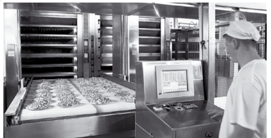
Koroški kruh na sodobnem avtomatu za polnjenje in praznjenje, ki je olajšal delo pekov (8-etažna računalniško krmiljena peč, leto 1999).
