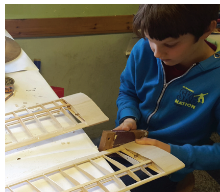
Izdelava kril klasične rebraste konstrukcije je natančno in dokaj zahtevno opravilo.
