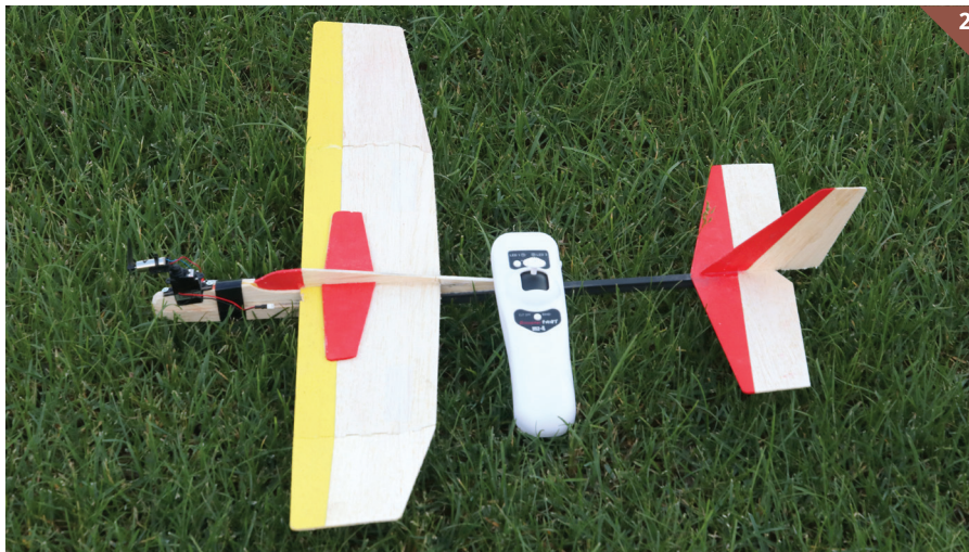
S pogonom vector line smo opremili tudi model drsalca hi-start G-24 avtorja Franka Zaica. Načrte za njegovo izdelavo smo objavili v reviji TIM št. 5 letnika 2012/13. Na modelu, ki je izdelan iz tanke balze, priporočamo le manjšo predelavo. Smrekovo letvico trupa bi veljalo nadomestiti s tankostensko cevčico iz ogljikovih vlaken premera 4 do 5 mm. Ta je ob praktično enaki masi bistveno bolj toga in trdna. Os pogonskega motorja smo obrnili za nekaj stopinj navzgor. V ta namen smo pod sprednjo prirobnico namestili matico M5. Akumulator smo po preverjanju položaja masnega središča na trup pritrčili z izolirnim trakom. Tako predelan model nas je prijetno presenetil s svojimi letalnimi sposobnostmi. Leti so se z vsega nekaj sekund podaljšali na več minut.
