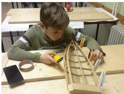
Model RV-čolna na električni pogon je izdelan iz lahke vezane plošče in letvic.
