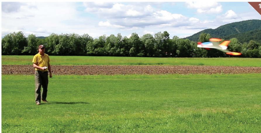
Model evro lovec, katerega načrt smo objavili v reviji TIM št. 3 letnika 2013/14, je izdelan iz deprona debeline 3 mm. Na hrbtišču trupa smo naredili dva utora in nanj privili servomehanizem z nameščenim potisnim propelerjem. Akumulator smo ovili z izolirnim trakom in ga na trup prilepili z obojestranskim lepilnim trakom.
