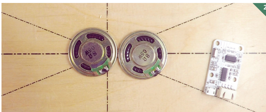
Zvočnik, ki sem ga uporabil, je imel samo 0,5 W in je bil zato šestkrat prešibak.
