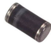
SMD-dioda. Obročna črta ob priključku označuje katodo diode.
